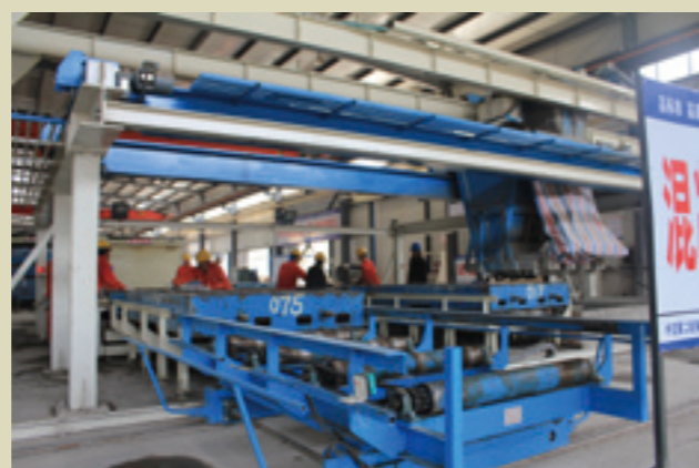
西宝轨枕生产车间流水线作业
